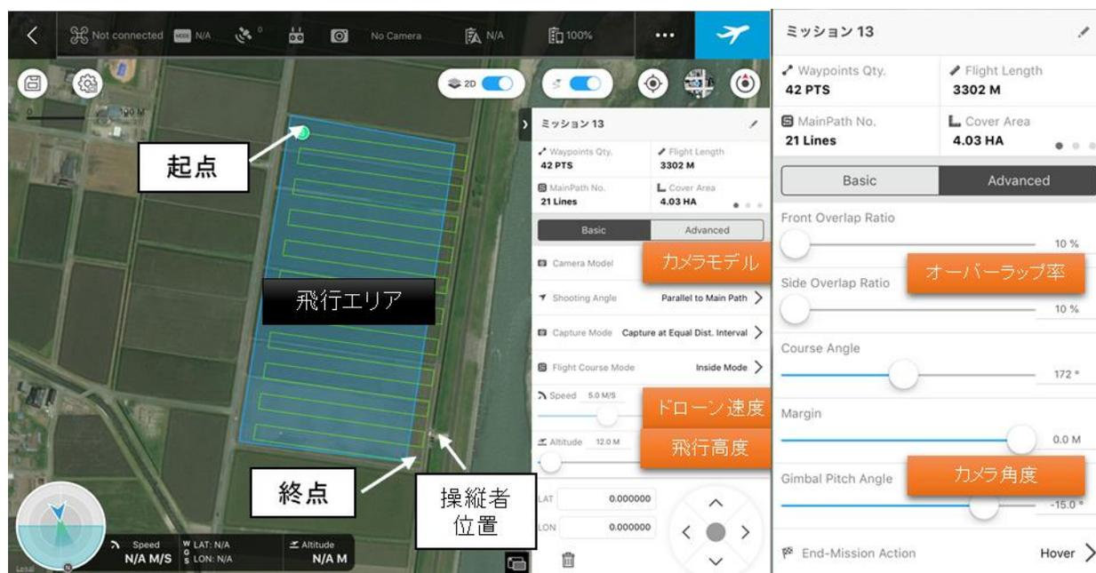
図 2 DJI GS PRO を用いた飛行ミッションの設定
