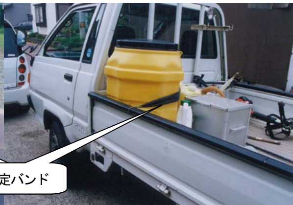
ポリタンクを固定した状態
