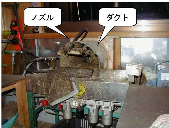
取り付けたダクト
