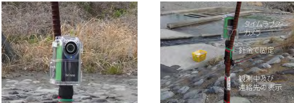
図3-6 タイムラプスカメラの設置例
