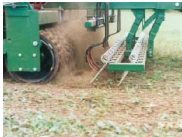
写真 - 2 グラスシーダの前面に取り付けた表層破碎装置（北農研、2000）
