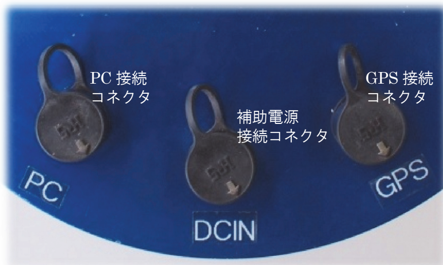
図 I—10 コントローラ部下面の各種接続コネクタ
