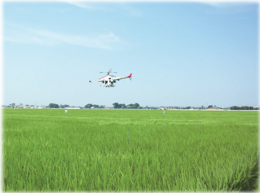
図IV-11 無人ヘリセンサシステムによる測定の様子 (産業用無人ヘリコプター:YAMAHA RMAX Type I)
