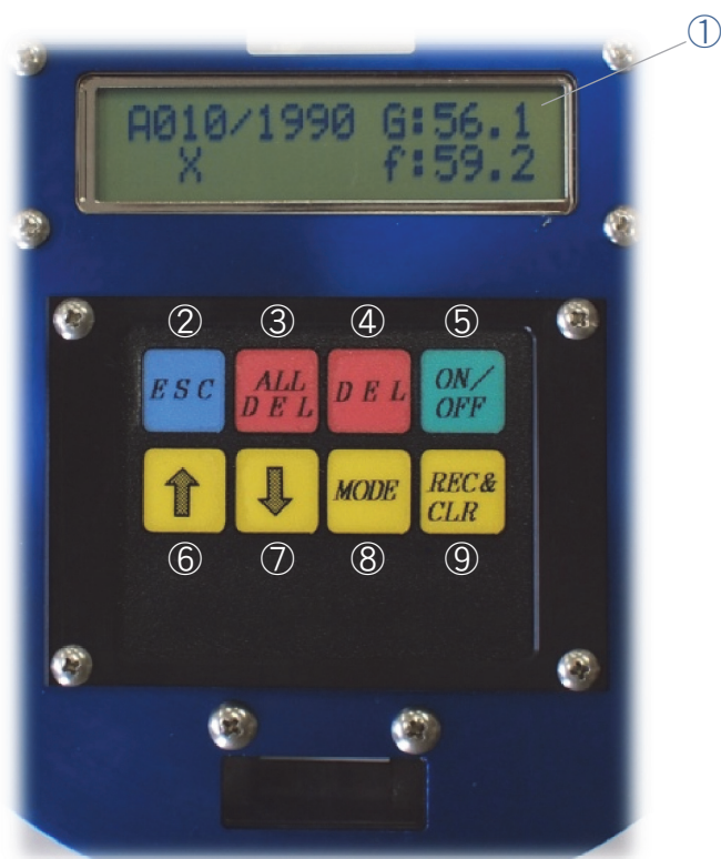
図 I —6 コントローラ部上面の液晶パネルと各種操作ボタン
