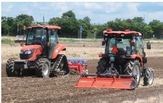
自動操舵システムを搭載したセミクロトラクター（左）と無人のアグリロボ（右）による大豆播種作業
