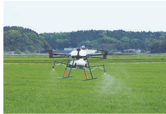
ドローンを用いた小麦の薬剤散布作業（作業の省力化と高能率化を実現）
