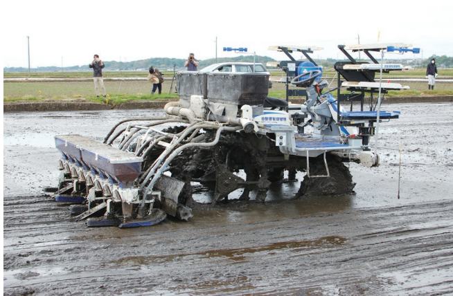
自動運転湛水直播作業。鉄コーティング「にじのきらめき」を播種
