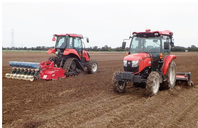
自動運転トラクタと有人トラクタとの協同作業によって省力化を実現
