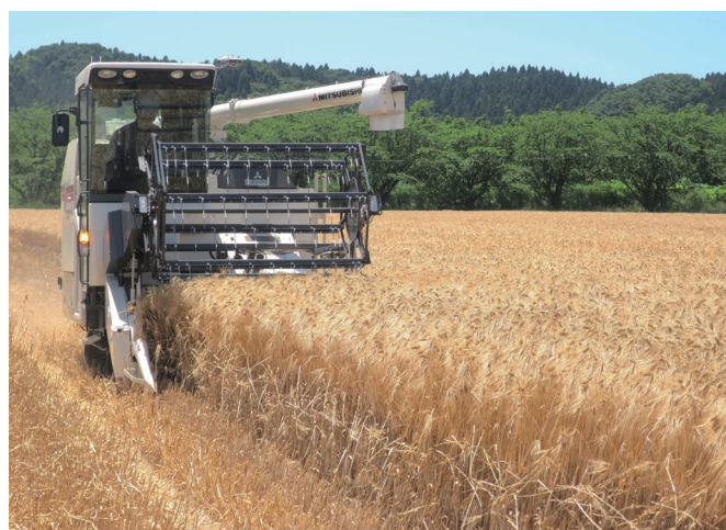
ほ場・収穫物情報を自動取得しながら大麦を収穫中のICT汎用コンバイン
