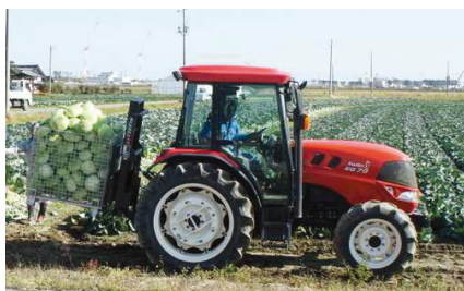
リアリフト (鉄コンテナ運搬用)
