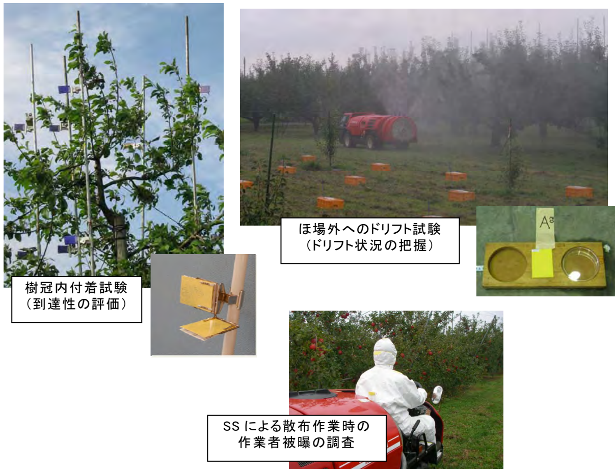
図2. 感水紙を用いたほ場試験の例（感水紙の設置例）
