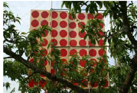
図8 樹冠視認度の調査方法 注) 幅1m、長さ2mの判定板を地上1.5~3.5mの高さの樹冠中央に4か所設置し、SSの通路位置から樹冠に向かって斜め下方から写真撮影し、赤丸の見え方で判定する。評価基準は、「0:全く確認できない、1:1/4未満が確認できる、2:1/4~1/2が確認できる、3:1/2以上が確認できる、4:全部確認できる」とする。
