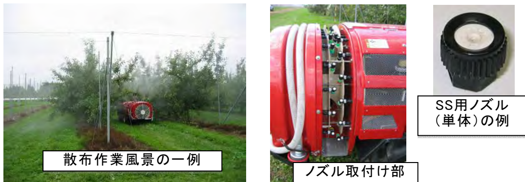
図1 SSによる薬剤散布作業およびSS用ノズルの一例
