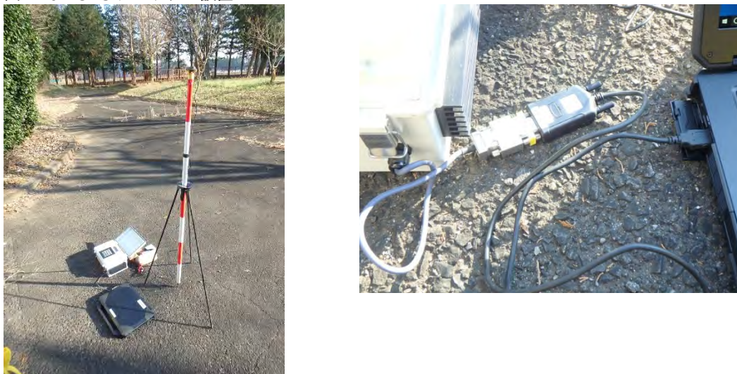
図 4.19 GPS アンテナの設置
