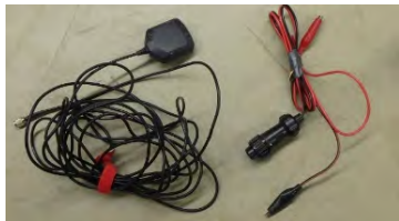
図 4.12 受信器付属品 (左: GPS アンテナ 右: 電源ケーブル)
