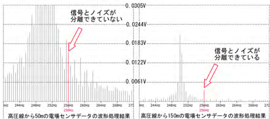
図 5.2 高圧送電線からの距離による受信状況の比較
