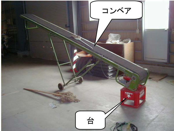
ベルトコンベアの下側へ台を入れた状態
