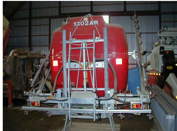
作目：共通 作業：防除、機械使用・管理 目的：作業安全 方法：反射シール付き、ブレーキランプ付き作業機を購入。
