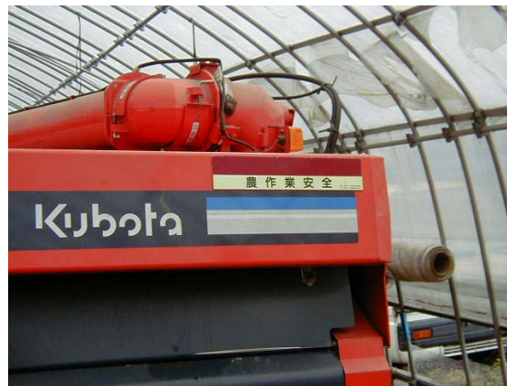
作目：穀類、水稻 作業：収穫、機械使用・管理 目的：作業安全 方法：コンバインへ反射シールを貼り付け。
