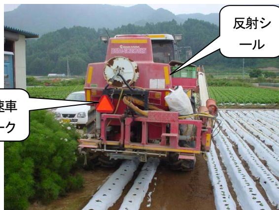
ブームスプレーへ低速車マークと反射シールを貼付けた状態
