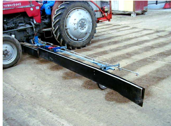
作目：てん菜 作業：防除 目的：環境保全 方法：漂流飛散を少なくするため、ノズルの前へ風除けを設置。作物の上のみに薬液が掛かるようにノズルを配置。
