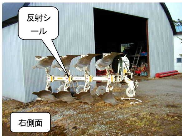
プラウに反射シールを貼った例（後方と側方から見えるように2面に貼った。）
