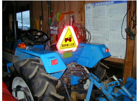
作目：共通 作業：機械使用・管理 目的：作業安全 方法：反射マークをトラクタへ貼り付け。
