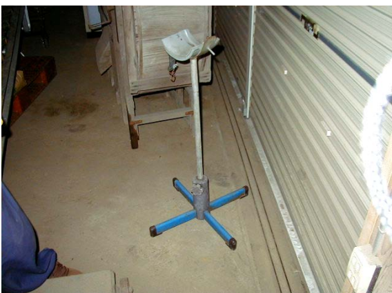
作目：穀類、水稻 作業：収穫、運搬 目的：重量物負担軽減、効率化・省力化 方法：トラックコンテナから乾燥機へ穀物を搬送するバネコンベアのホースを支える器具を製作。
