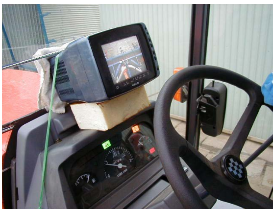
作目：共通 作業：共通 目的：作業姿勢改善 方法：キャビン後部にビデオカメラを、ハンドル付近にモニターテレビを取り付けて後方確認。振り返り動作解消し、首、腰への負担軽減。
