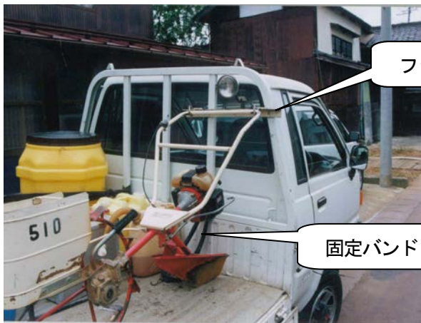
溝切り機を固定した状態
