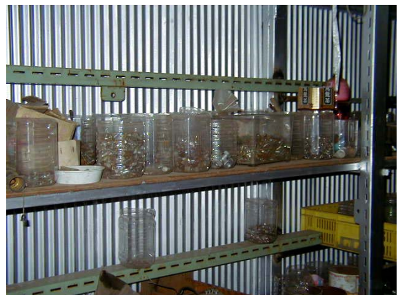
作目：共通 作業：機械使用・管理 目的：施設整備、効率化・省力化 方法：ネジ等部品を種類別、大きき別に収納。見やすいように透明なペットボトルを利用。
