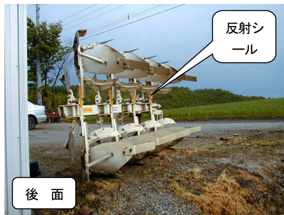
プラウに反射シールを貼った例（後方と側方から見えるように2面に貼った。）
