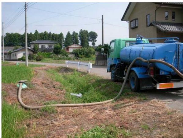
図 2-11 バキュームカーでの液肥施用方法
