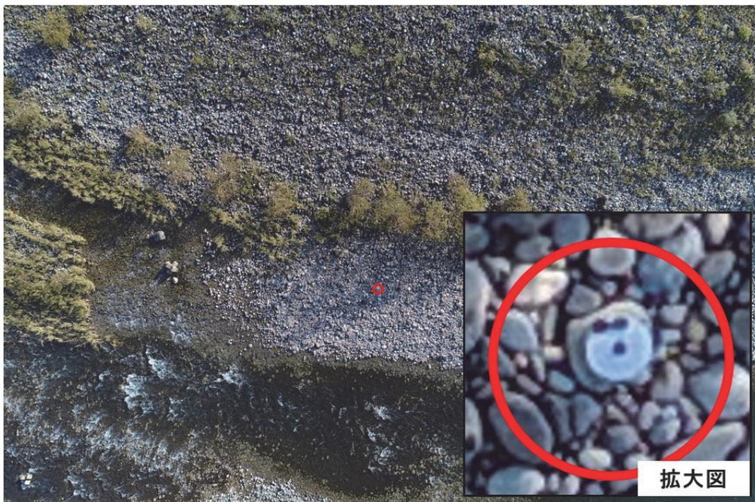
図 2-6 対空標識兼用 GNSS 受信機を高度約 40m の上空から Phantom4 Pro で撮影した画像
