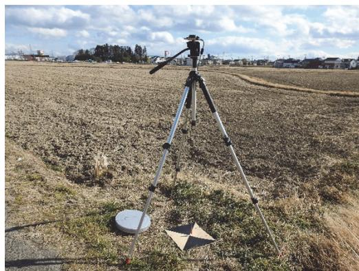
図 A ① -3 対空標識の計測（左）、グラウンドプレーン（巻末付録 E）を使用して三脚に搭載（右）
