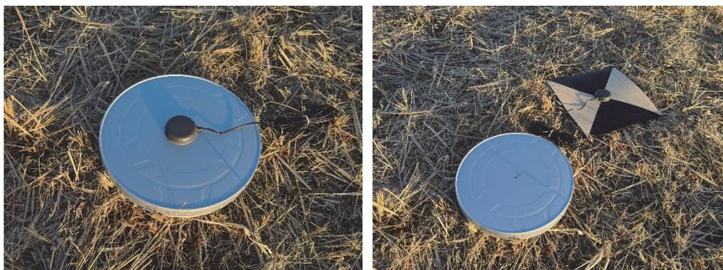
図 2-1 対空標識兼用 GNSS 受信機（左）、別途用意した対空標識を計測している様子（右）
