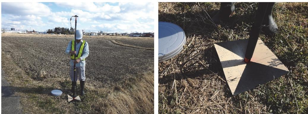
図 C ② -1 一脚による GNSS 観測（左）、対空標識中心の確認（右）
