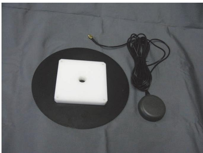
図 A ⑥ -1 GNSS アンテナ用グランドプレーン
