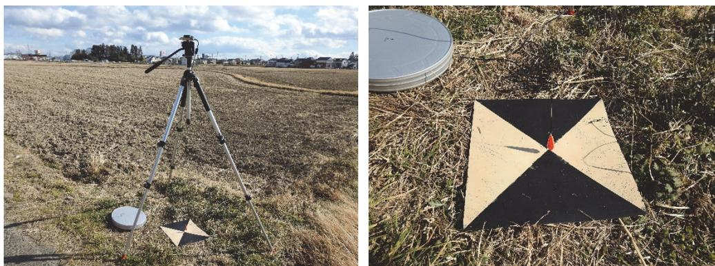
図 C ①-1 三脚による GNSS 観測機材の設置（左）、対空標識中心の確認（右）
