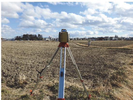
図 D ② -2 回転レーザーでの測量の様子
