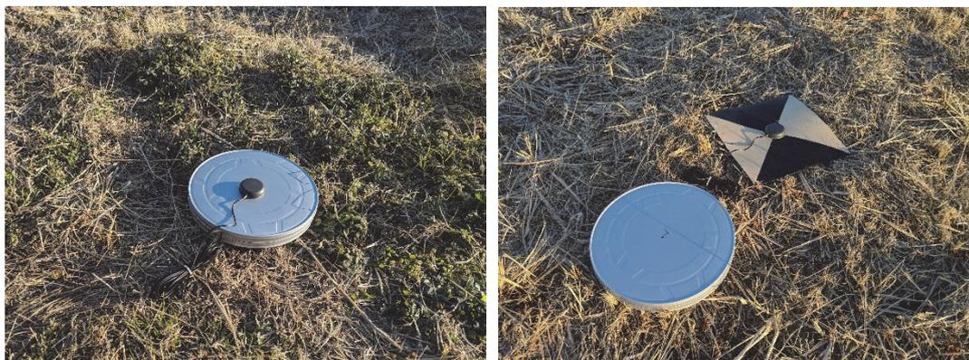
図 4-1 ローカル基準局の設置 (左)、移動局での観測 (右)
