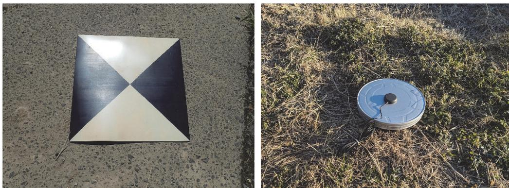
図 3-3 対空標識（左）、対空標識兼用 GNSS 受信機（右）
