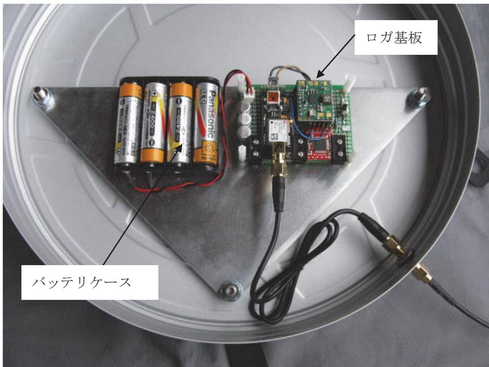
図 A ① -2 対空標識兼用 GNSS 受信機（内部）
