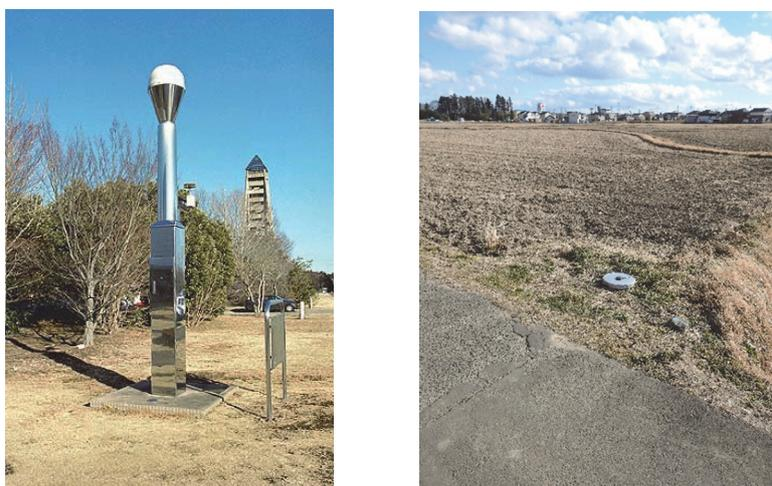
図 2-2 電子基準点（基準局）と対空標識兼用 GNSS 受信機（移動局）の様子
