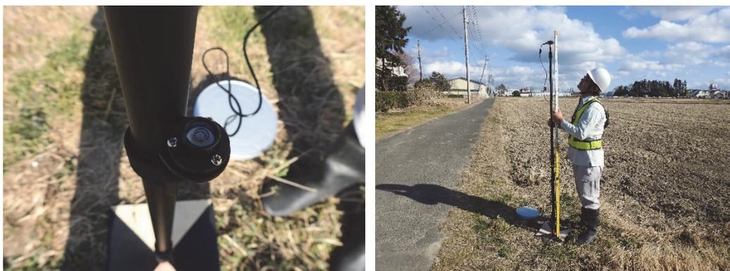
図 C ② -2 水準器で一脚の傾きを調整（左）、アンテナまでの高さの計測（右）
