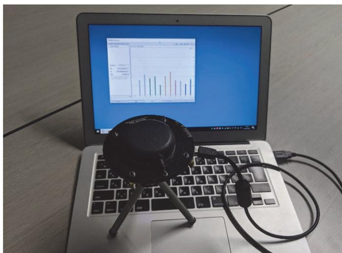
図 A ④ -1 NEO-M8T モジュールをパソコンに接続して rtknavi で観測ログデータを取得している様子
