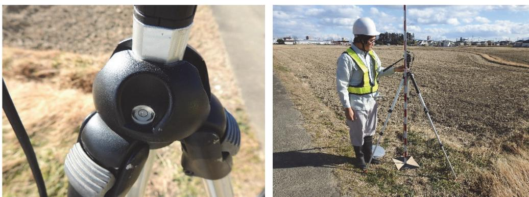
図 C ①-2 水準器で三脚の傾きを調整（左）、アンテナまでの高さの計測（右）
