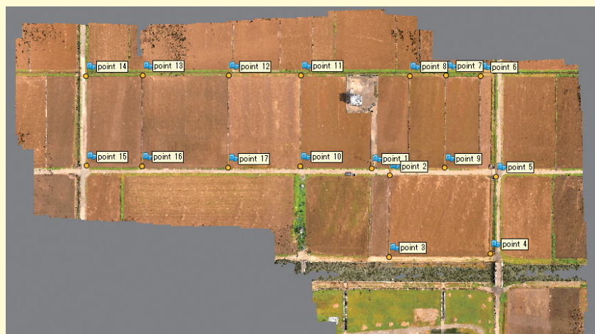
図 3-1 地上基準点の設定イメージ
