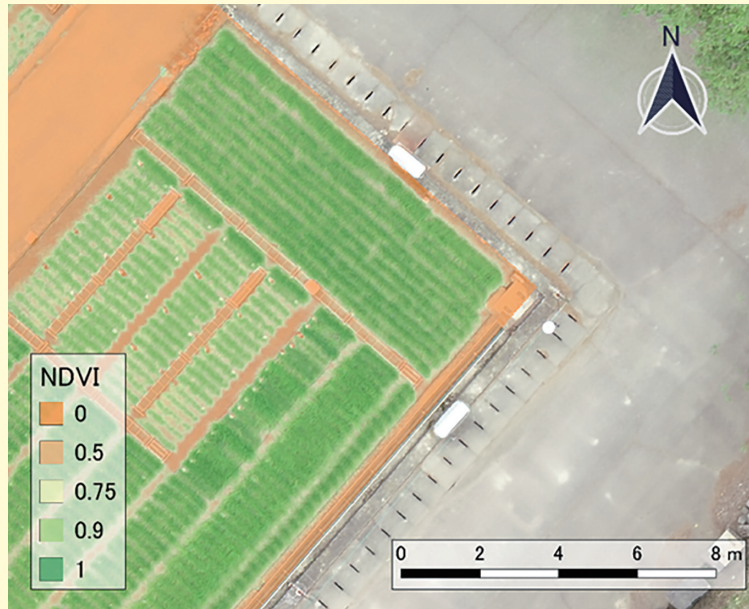
図 1-3 小型 GNSS 受信機を用いて干渉測位した位置情報を使用して作成したオルソ画像
