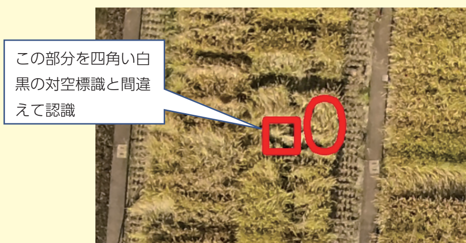
図 6-28 倒れた水稻を対空標識と間違えた例
