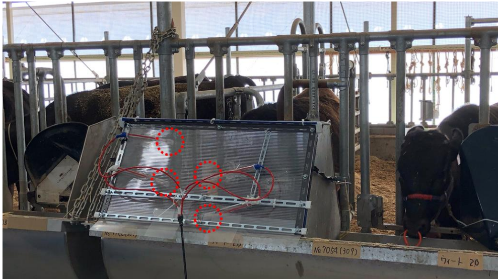
写真 3-2 飼槽蓋にガス吸引口を設置した事例 丸印はガス吸引口の位置を示す。
