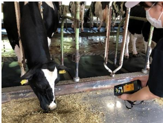
写真 1-4 LMD 法による測定状況
