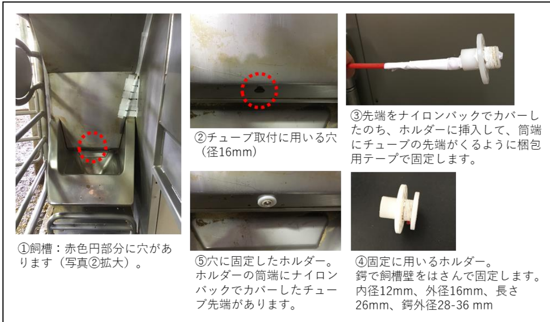
図 2-6-2 Lely 社 Astronaut A3 Plus (広島大学) での設置例 飼槽の飼料投下口上縁 (黄色円部分) にある穴を利用してチューブを固定する方法。
