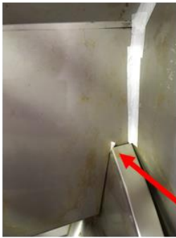
図 2-6-3 Lely 社 Astronaut A3 Plus（広島大学）での設置例 飼槽壁面の隙間を利用して固定する方法。
