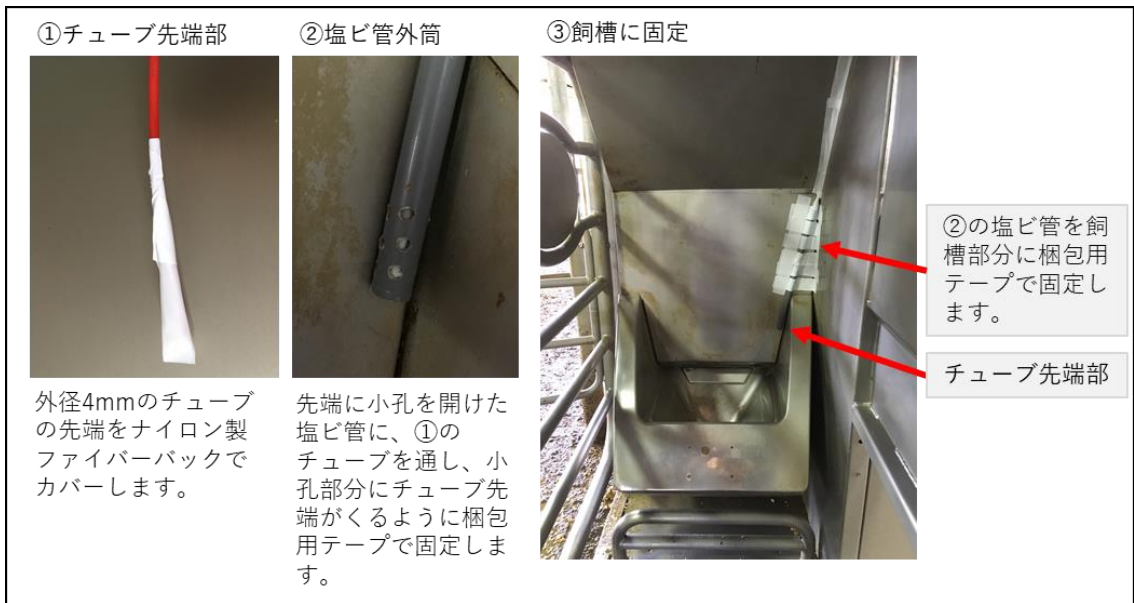
図 2-6-1 Lely 社 Astronaut A3 Plus (広島大学) での設置例 塩ビ管外筒を用いて飼槽縁に固定する方法
