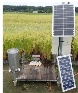
写真2 水田の浸透水調査システム
