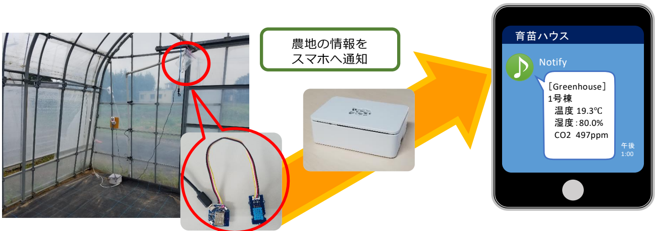
図1 温室の温度情報をスマホに自動転送する仕組み
