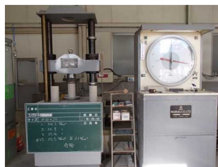
(b) 圧縮強度試験結果
