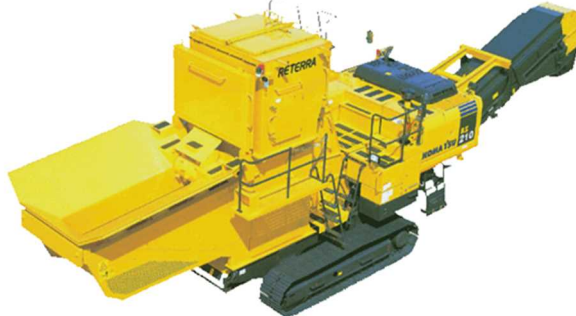
写真 5. 5-2 自走式土質改良機(機械攪拌)によるセメント改良
