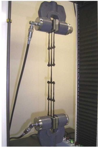
写真 6.5.2-1 オテキスタイルの引張強度試験（品質管理試験）
