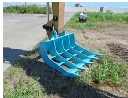
写真 5. 5-1 バックホウによるセメント改良
