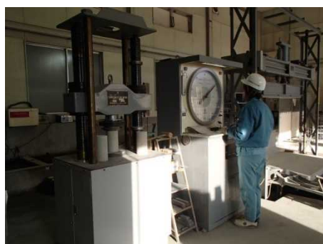
(a) 圧縮強度試験状況
