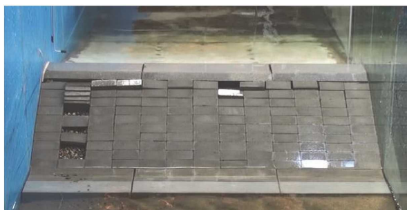
参考図 1.3-5 越流終了後の裏法被覆工(ケース4-2-10m)
