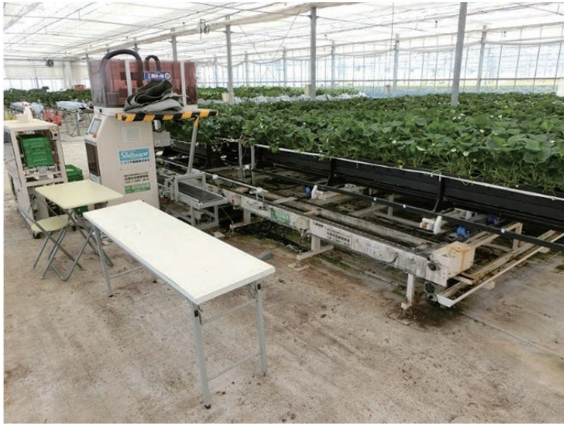
図1 GRAにおける栽培・自動収穫現地実証試験
