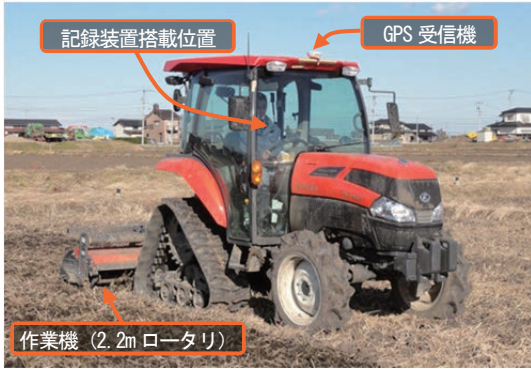
図1 記録装置を搭載したトラクタ
