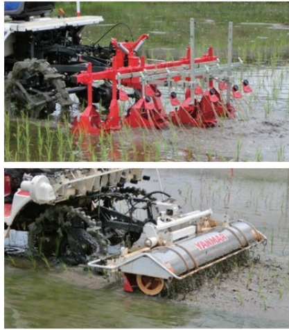
上：試作機(けん引式)、下：対照機(PTO 駆動式)
