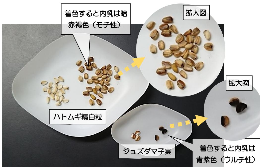
図IV-2 ヨウ素試液（希釈）によるデンプンの着色
