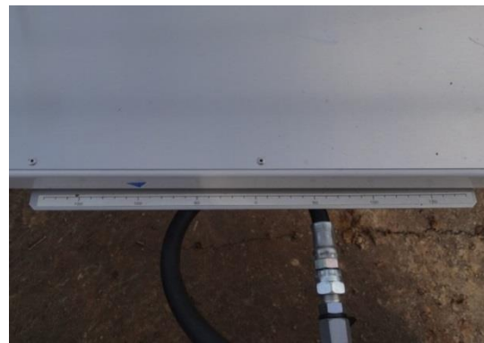
巻取りアタッチメントのスライド機構目盛（操縦席のスイッチで操作）
