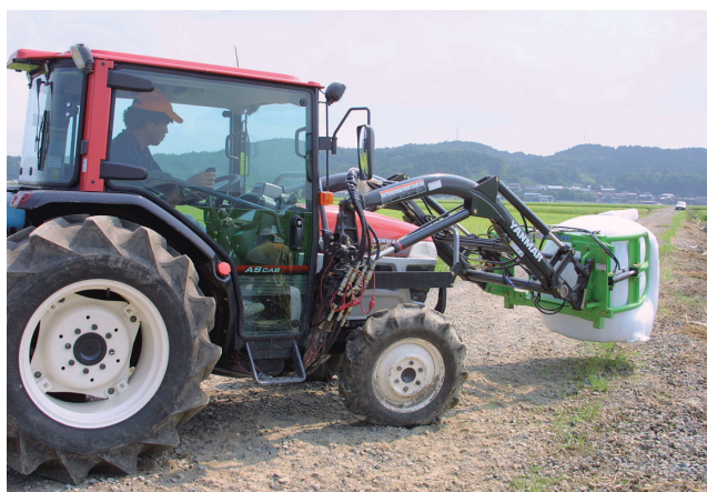
オンボード油圧計量装置での測定
