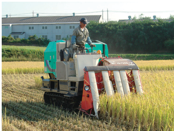
コンバイン型収穫機（タカキタWB1000）
