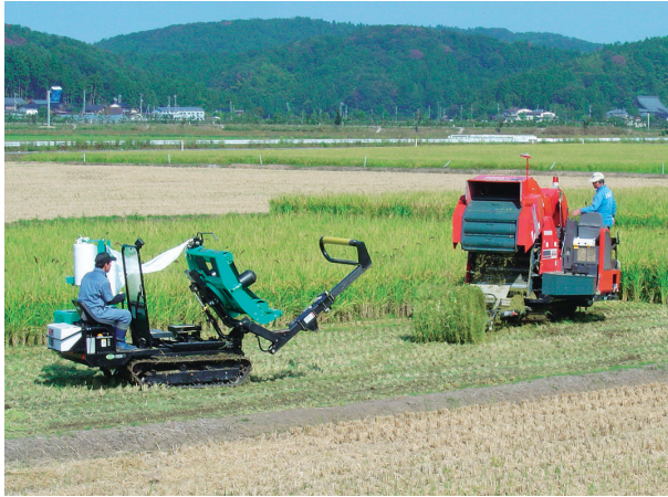
べールラップとの連携作業 (斜めに後退して排出すると作業しやすい)
