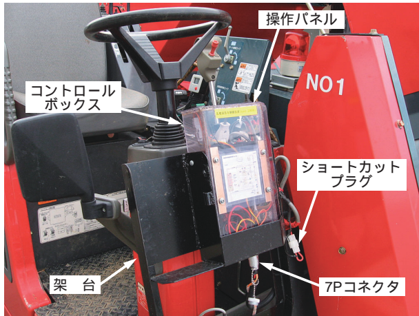
コントロールボックスの取り付け状態
