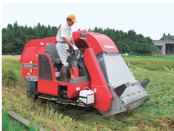
純正の乳酸菌散布装置を装着した フレール型収穫機（YWH1400A）
