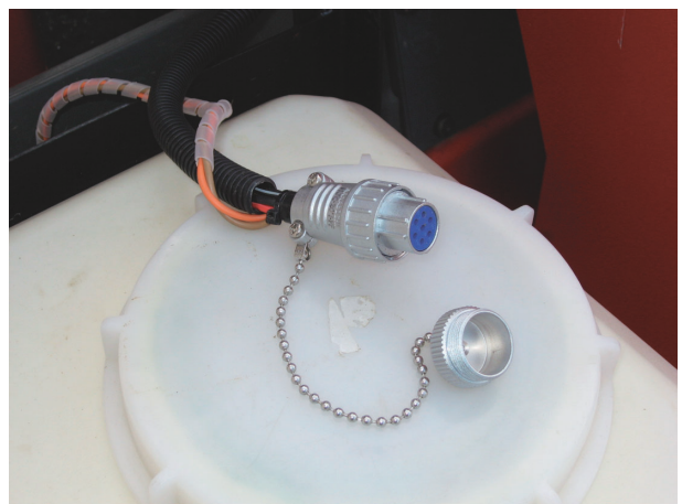
コントロールボックスの着脱を容易にするために採用した7Pコネクタ
