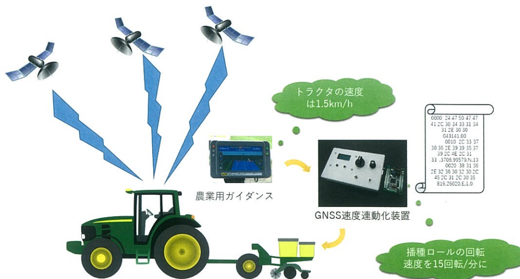
図 GNSS 信号を利用した構成の播種技術の概略図
