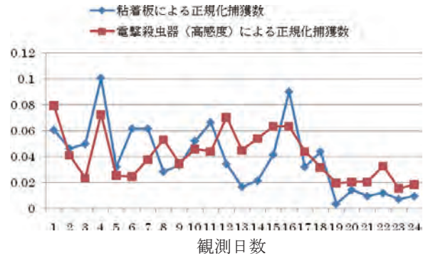
図7 電撃殺虫器(高感度)によるカウント数と粘着板との正規化された値の比較(横軸は6月4日からの観測日数)
