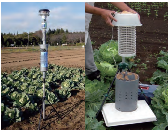
図4 実験に用いたフィールドサーバと電撃殺虫器
