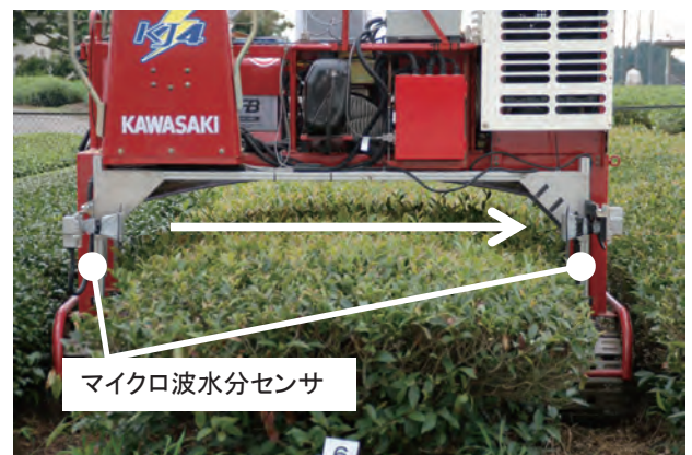
図4 計測作業状態
