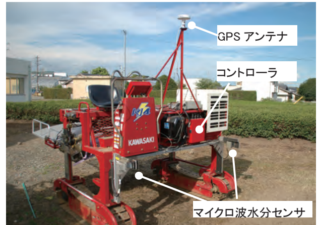
図3 計測システムの概要
