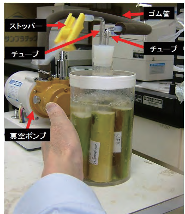
図5 減圧浸透法による窒素固定エンドファイト新規接種法
