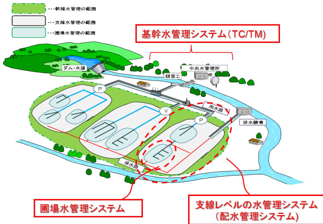
図 1.2-(1) 次世代型水管理システムの概要図
