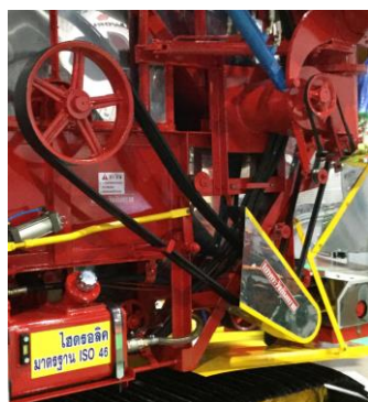
図2 むき出しのベルト
