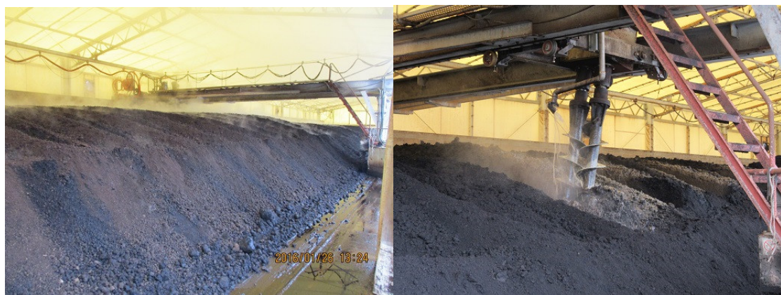
図 5-16 スクリュー式 L 型地走式攪拌機による攪拌の様子 (遠矢原図)
