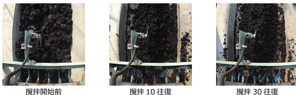
図5-2 ロータリー式小型造粒装置における造粒中の堆肥形状変化（荒川原図）
