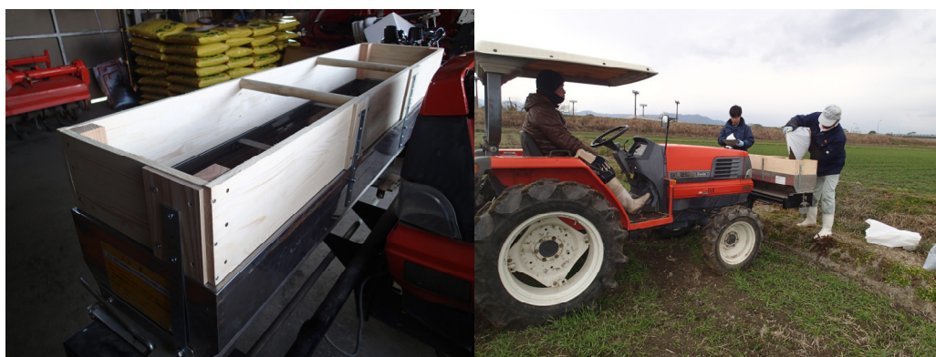
図 2-13 ライムソーの容量を 60kg から 80kg に増量し圃場の端で補充可能に
