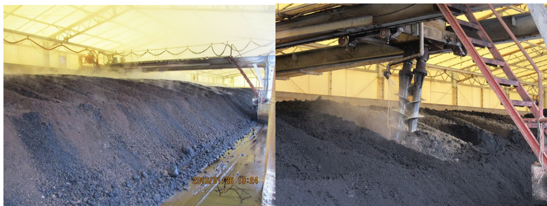
図 5-16 スクリュー式 L 型地走式攪拌機による攪拌の様子 (遠矢原図)
