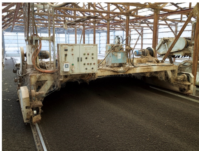
図 5-7 ロータリー式攪拌発酵装置（株晃伸製機製）（堂本原図）
