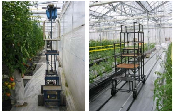
写真2 高所作業車 (左) 自走式 (右) 手動式
