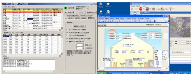
図 5 パソコンで動作するウエックス対応ソフトウェアの例(左: 警報等の監視ソフト、右: 機器動作状態閲覧と計測制御情報のデータベース化ソフト)
