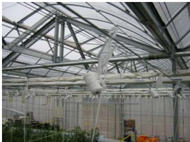
写真3 つる下げ・誘引に使用する器具の例 (左) トマHOOK (中) バトーボビン (右) 誘引用クリップ
