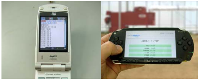
図 4 携帯情報機器で遠隔監視・操作した例(左: 携帯電話による気温の経時変化監視例、右: 携帯ゲーム機による暖房機操作例)
