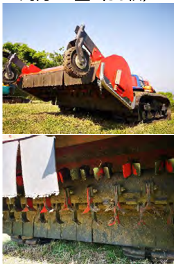
無線トラクタ装着型 刈刃: Y型 (36枚)
