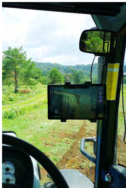
トラクタ内の GPSガイダンスの様子
