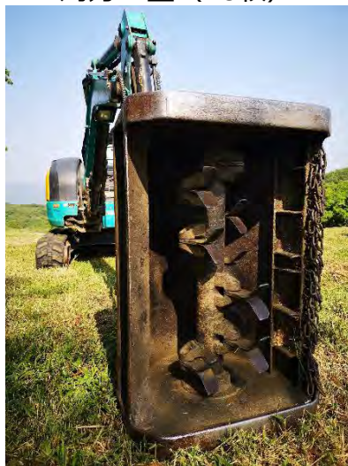
油圧ショベル装着型 刈刃: Y型 (18枚)
