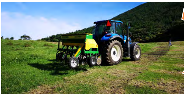
2022/9/5 簡易更新機による永年生寒地 型牧草の播種、GPSガイドスを活用し肥料 としての鶏ふんの効率的散布
