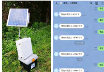
5) 電気牧柵 電圧監視技術
