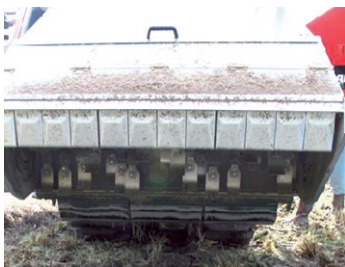
フレール刃 (平均切断長100～150mm)
