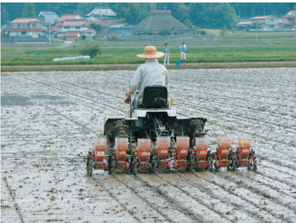
古いタイプの直播機も、鉄コーティング 種子の条播に利用できる。
