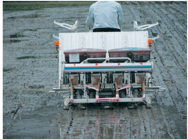
側条施肥機を利用した条播 落水しているときはフロートを下げて播種する。わだちが残らず、種子が田面になじむ。
