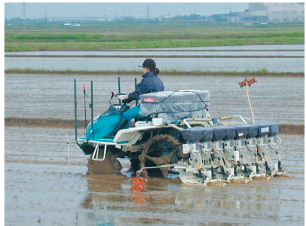
最新型の田植機兼用の直播機も表面播種 に切り替えて利用できる。
