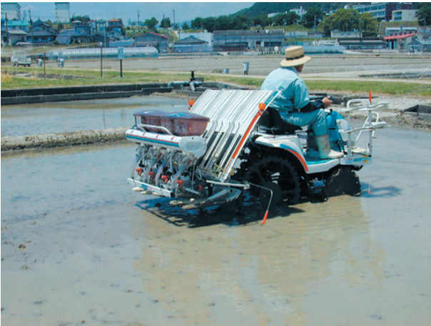
側条施肥機を利用した条播 水が多いときはフロートを上げて播種する。
