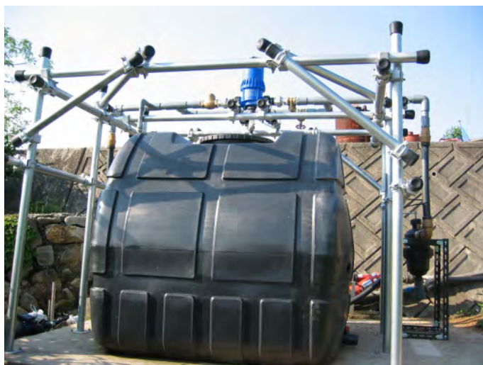
写真2 K組合で共用している大型の液肥タンクと液肥混入器
