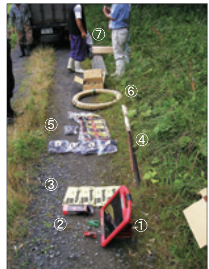
牧柵資材（手前より、①電牧器、②テスター、③危険表示板、④アース線、⑤碍子、⑥電牧線、⑦牧柵支柱など）
