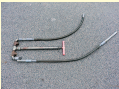
自転車の空気入れを利用した給水施設の水吸引装置
