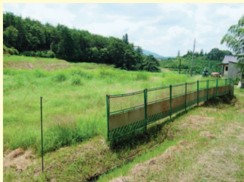
建設用の廃資材を利用した牧柵
