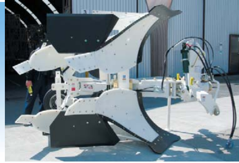
写真4 畑用二段耕1連リバーシブルプラウ
