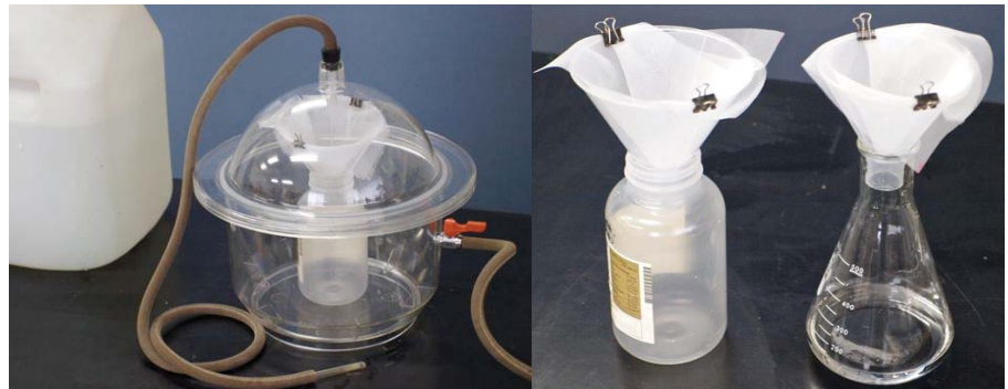
図 2 吸引ろ過装置の製作例
