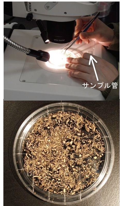
図 2-3-1 種子の選別作業（上）と選別用のプレートにマス目付きのシャーレを使用した例（下）。左手に持っているのは種子回収用のサンプル管。
