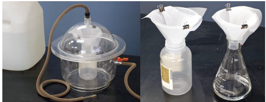
図 2 吸引ろ過装置の製作例
