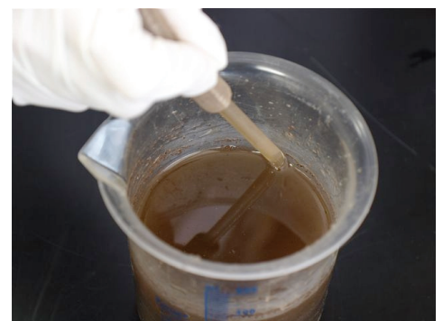
図7 すくい取り法で取りきれなかった残さの吸引による回収
