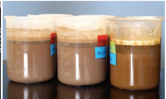
図5 攪拌後、概ね 10 分 (左)、20 分 (中)、30 分 (右) 経過した土壌サンプル
