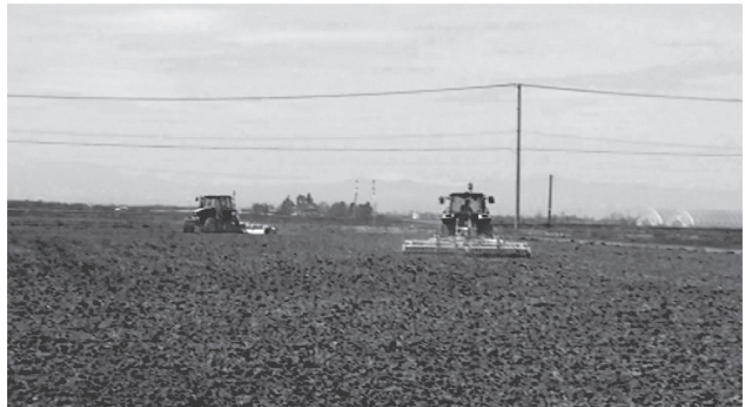
写真1 大区画圃場(2.8ha)では、レーザーレベラーが2台同時に稼働
