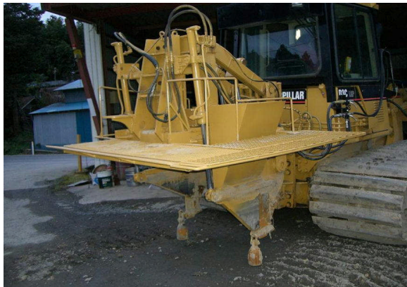
図9 補助孔掘削装置(農工研)
