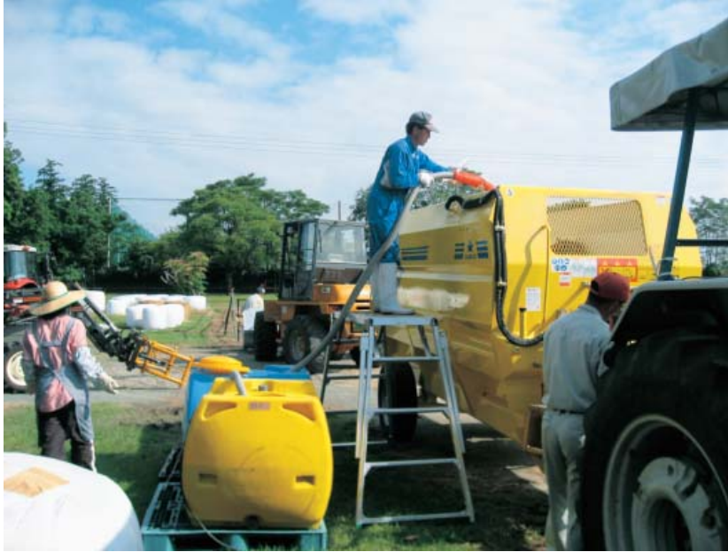
写真 3-1 ポリタンクから汚泥ポンプを用いてミキサーへ濃縮液投入
