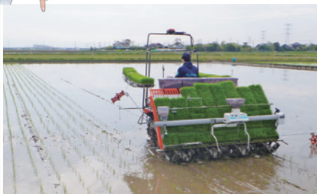
写真左:塩入先生直筆の試験設計書 ※試験開始から6年後の1931年時のもの 写真右:可変施肥田植機の実証試験の状況 (2020年)
