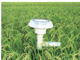
水田内の気温と湿度を自立型微気象測定システム(MINCER)により高精度で連続測定
