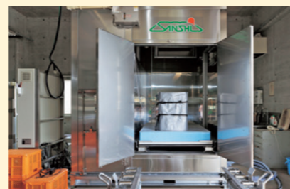
一度に、総量480キログラムの種イモが消毒できる。パレット積載なので、フォークリフトでの積み込み作業が可能。
