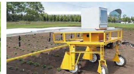
自動検出プログラムを搭載したほ場管理車両 (異常株検出支援システム)
