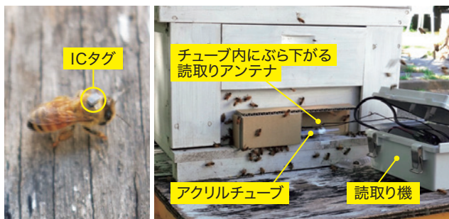
図5 ICタグをつけたミツバチ(左)と巣箱の前のICタグ読取りゲート(右) 巣箱の前に右図のようなゲートを設置して、ミツバチが巣から出入りするときに必ず図中のアクリルチューブを通るようにし、チューブ内にぶら下げた読取りアンテナの下をICタグ付きのミツバチが通過すると、アンテナにつながった読取り機に入出力が記録されるシステム。
