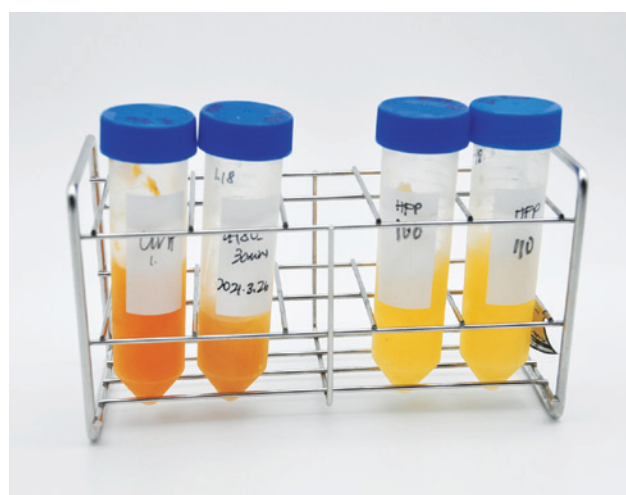
図5 リンゴピューレの保存(5°C、1年間) 左から未加熱、温浴加熱(80°C 30分)、高周波パルス加熱(100°C 4秒)、 高周波パルス加熱(110°C 4秒)
