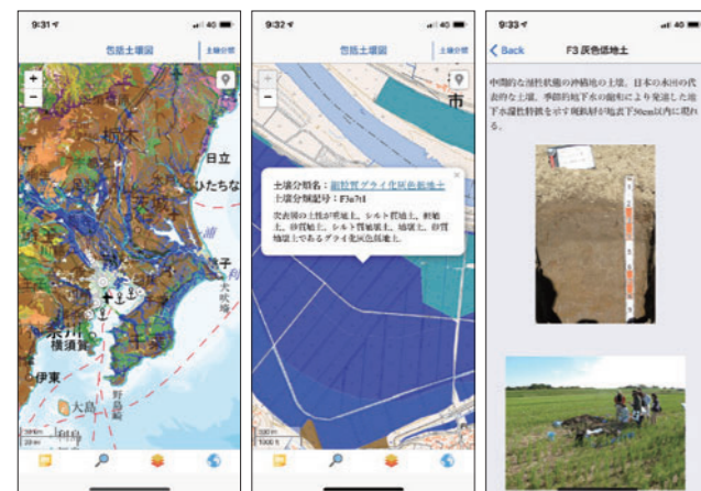
図4 e-土壌図IIの土壌図閲覧機能 左は縮尺20万分の1相当の全国土壌図、中は縮尺5万分の1相当農耕地土壌図、右は土壌種の解説。
